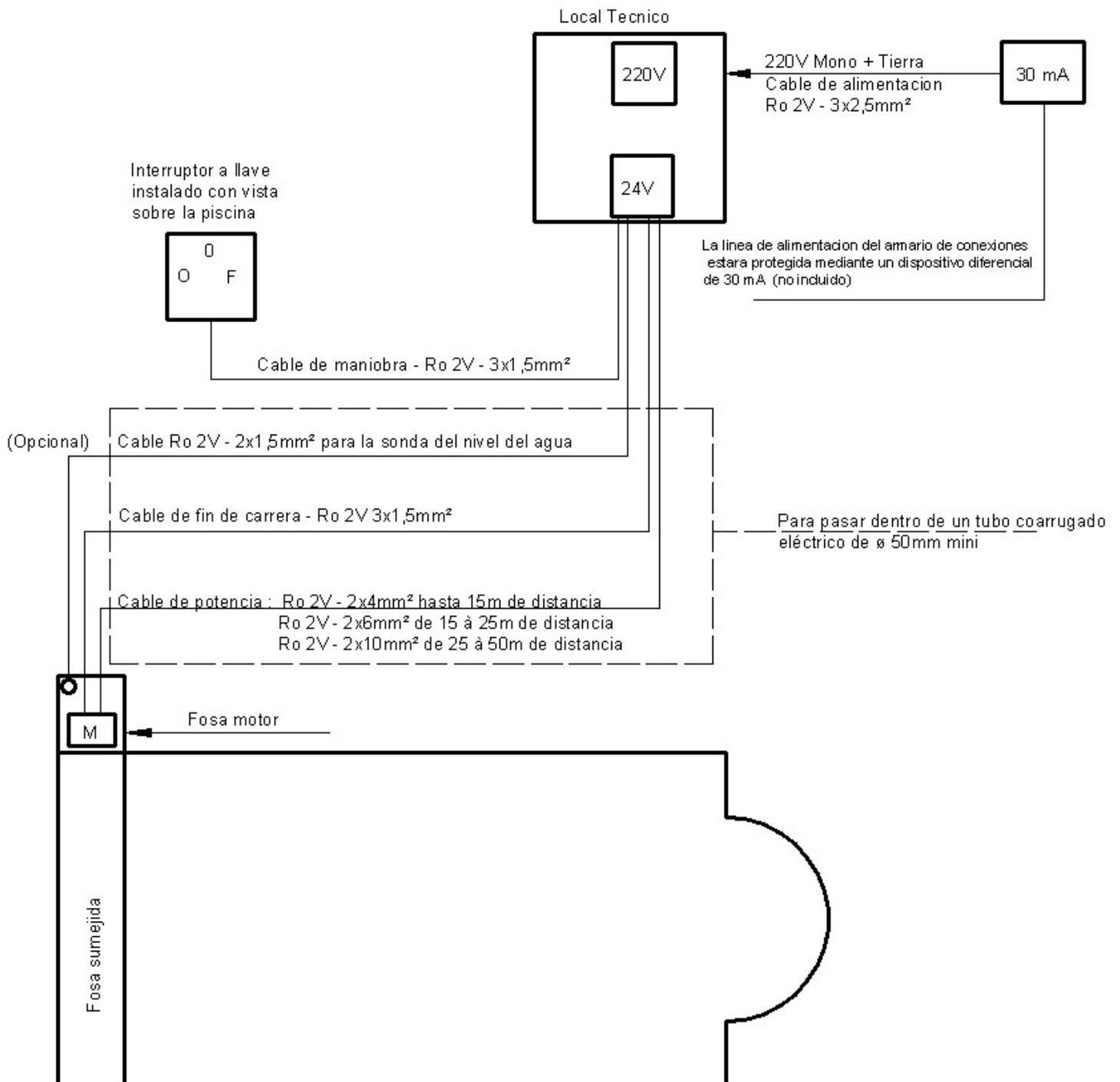
Nota: En el caso de un cajon enterrado con muro de separacion, es imprescindible instalar un regulador de nivel de agua
