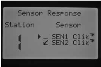
Sólo Sensor 2 programado para la Estación 1
