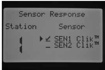
Sólo Sensor 1 programado para la Estación 1
