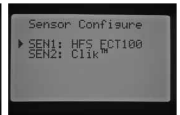
SEN 1 - SENSOR DE CAUDAL (HFS FCT100) SEN 2 - SENSOR TIPO CLIK
