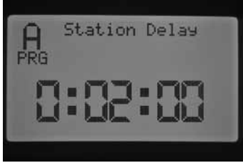
EXP: RETRASO ENTRE ESTACIONES PARA EL PROGRAMA A, 2 MINUTOS
