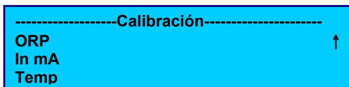
Mediante las teclas **Arriba y Abajo**, seleccionar la sonda a calibrar y presionar **ENTER**.
