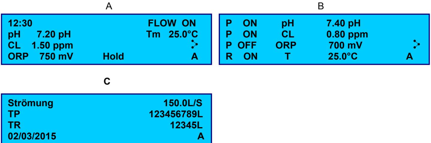
Mit den Tasten rechts/links kann man zwischen Anzeige A oder B wählen
