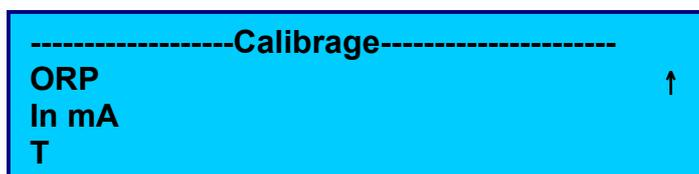
Au moyen des touches **Haut** et **Bas** sélectionner la sonde à calibrer et appuyer sur **ENTRÉE**.
