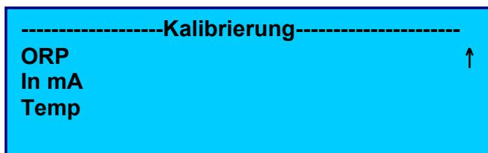
Mit den Tasten **Auf** und **Ab** die Sonde, die kalibriert werden soll, auswählen und **ENTER** drücken.
