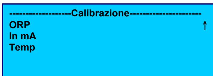
Tramite i tasti **Su** e **Giu** selezionare la sonda da calibrare e premere **ENTER**.
