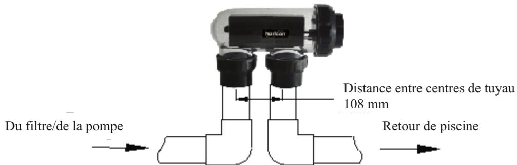
**ATTENTION :** Il est primordial que l'installation de tuyauterie et l'équipement ne permettent pas le rassemblement et l'accumulation des gaz générés par la cellule.
