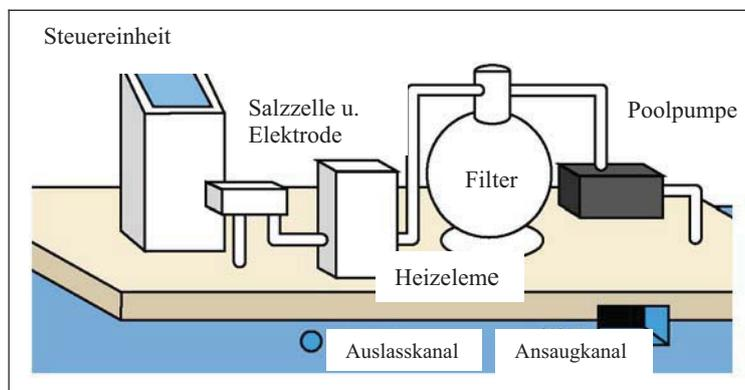
Wenn die Zelle positioniert wurde, verbinden Sie das schwarze mehradrige Kabel mit der Zelle. Der blaue Draht muss an die blaue Klemme angeschlossen werden. Das Kabel wurde so konzipiert, dass es von unterhalb der Zelle kommt. Achten Sie darauf, dass die Flügelmuttern richtig festgezogen sind, um einen guten Kontakt zu gewährleisten.
