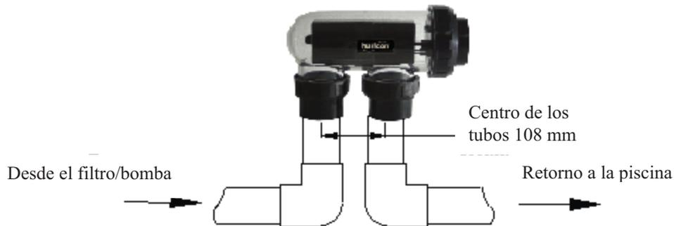
**ADVERTENCIA:** Es esencial que la tubería y el equipo no permitan que se acumulen los gases generados a partir de la celda.
