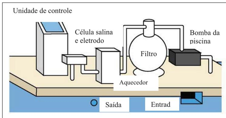
Uma vez instalada a célula, conecte o cabo multifios à célula. O fio azul deve ser conectado ao terminal azul. O cabo é projetado para vir por baixo da célula. Certifique-se de que os parafusos borboleta estejam apertados corretamente, de modo a garantir bom contato.
