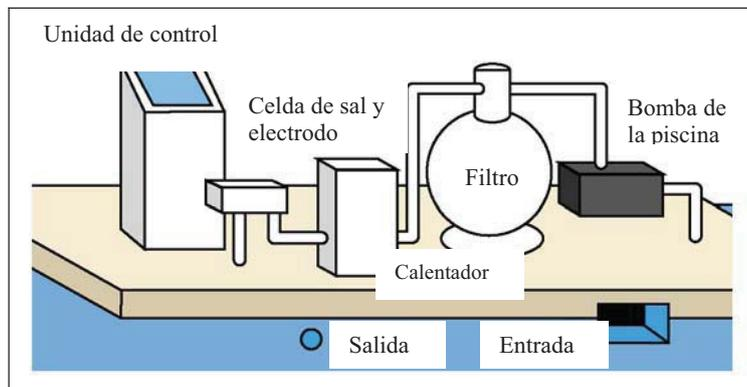
Una vez que se coloca la celda, conecte el cable negro de alma múltiple a la celda. El cable azul debe estar conectado al terminal azul. El cable está diseñado para derivar de la parte inferior de la celda. Asegúrese de que las tuercas de oreja estén ajustadas correctamente para permitir un buen contacto.
