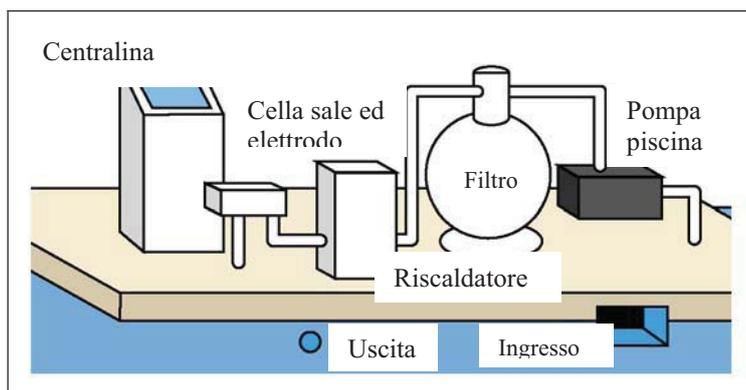
Dopo aver posizionato la cella, collegare il cavo multipolare nero alla cella. Il filo blu deve essere collegato al morsetto blu. Il cavo è stato progettato per arrivare dalla parte inferiore della cella. Accertarsi che i dadi ad alette siano serrati correttamente al fine di garantire un buon contatto.
