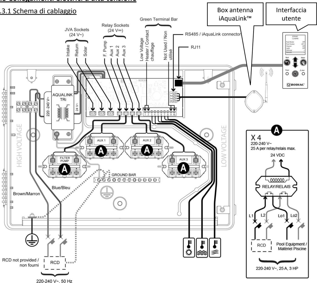
**⚠ « RCD » (= Residual Current Device): dispositivo di protezione differenziale. Ogni alimentazione elettrica collegata all'unità AquaLink TRI® deve essere protetta da un interruttore differenziale da 30 mA e da un interruttore automatico o un fusibile di protezione dedicato di taglia idonea.**
