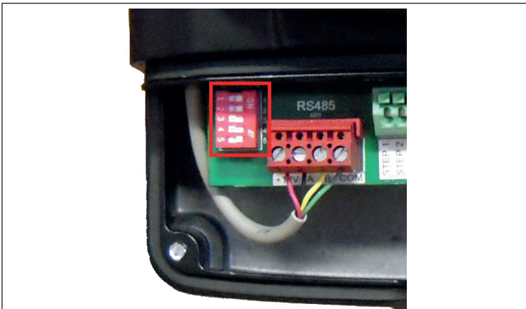
Posição dos switches para a pilotagem por AquaLink® TRI
