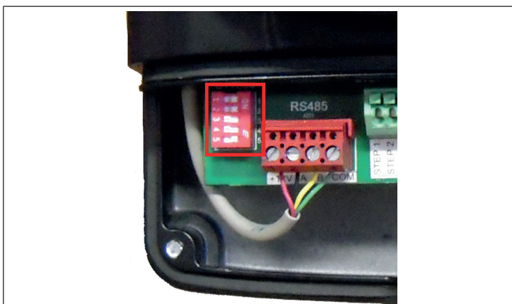
Posição dos switches para a pilotagem por iQPUMP
