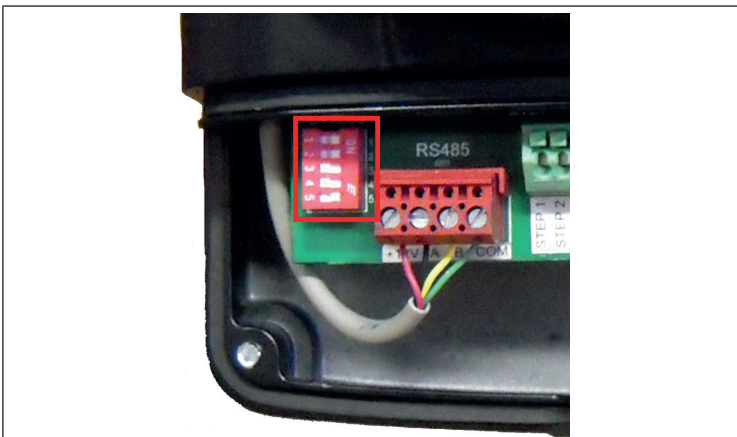
Posição dos switches para a pilotagem pela interface do utilizador
