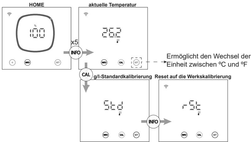
Im Menü Temperaturkalibrierung ermöglicht das Gerät die Durchführung einer Standardkalibrierung oder das Zurücksetzen der aktuellen Kalibrierung auf Werkseinstellungen:
