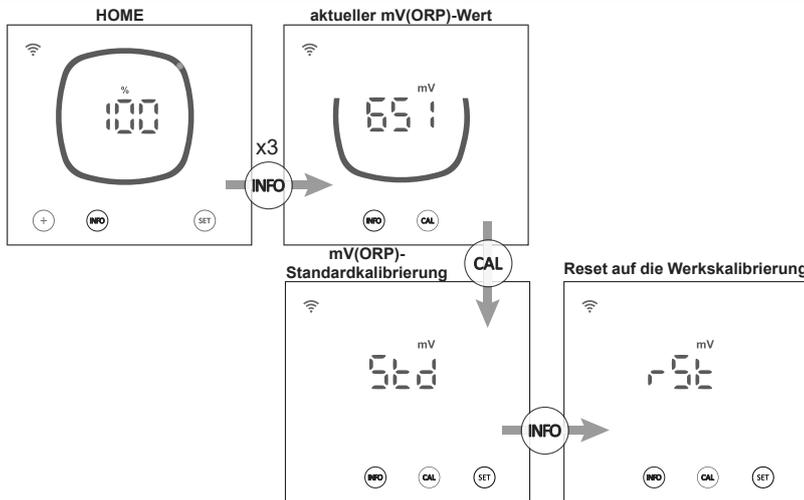
Im Menü mV(ORP)-Kalibrierung ermöglicht das Gerät die Durchführung einer Standardkalibrierung oder das Zurücksetzen der aktuellen Kalibrierung auf Werkseinstellungen:
