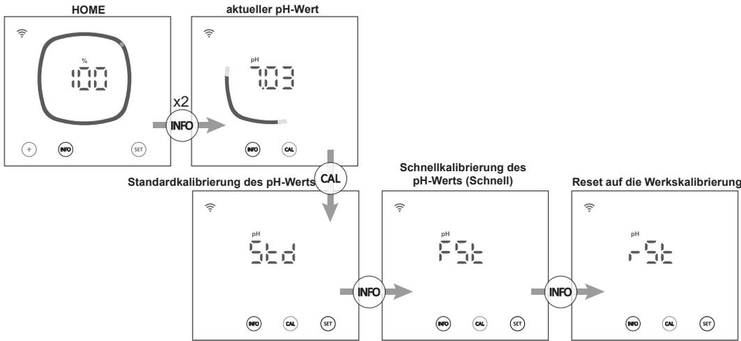
Im Menü pH-Kalibrierung ermöglicht das Gerät die Durchführung einer Standardkalibrierung, einer Schnellkalibrierung oder eines Resets der aktuellen Kalibrierung auf Werkseinstellungen:
