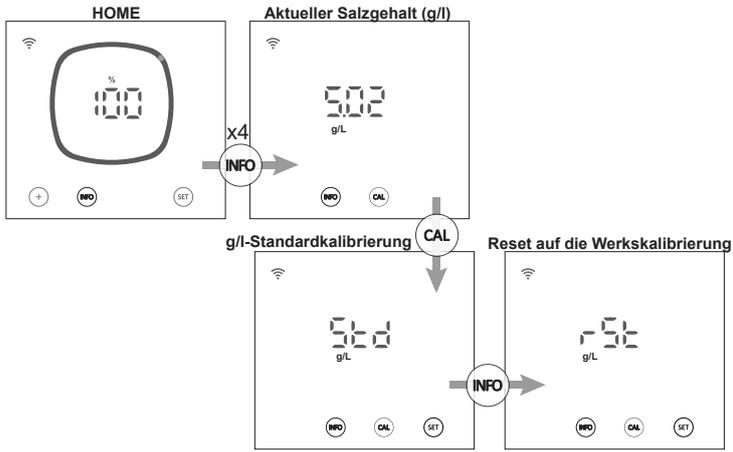
Im Menü Kalibrierung des Salzgehalts ermöglicht das Gerät die Durchführung einer Standardkalibrierung oder das Zurücksetzen der aktuellen Kalibrierung auf Werkseinstellungen:
