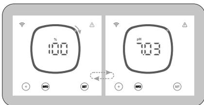
3. Modell Ei2 iQ evo pH/ORP: Schaltet zyklisch zwischen der aktuellen Produktion (%), dem pH-Wert und dem Redoxpotenzial (ORP) (mV) des Schwimmbeckens um.
