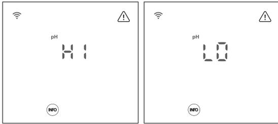
Bei einem Alarm wegen zu hohen pH-Wertes schaltet sich die pH-Pumpe aus Sicherheitsgründen ab.
