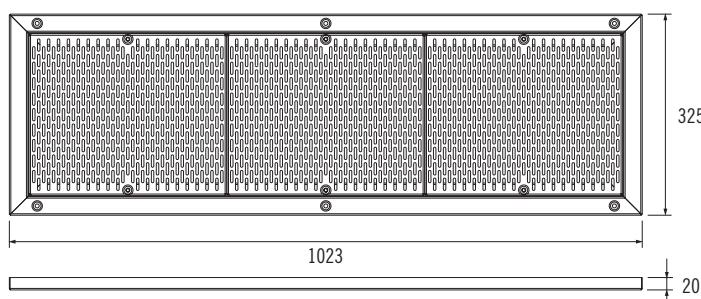
**Reja de aspiración gran caudal hormigón / High flow suction grill concrete** hasta / up to **190 m<sup>3</sup>/h** CÓDIGO / CODE **35370**
