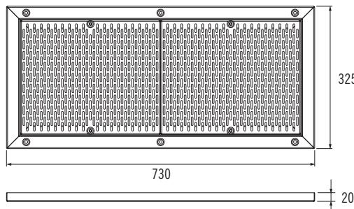
**Reja de aspiración gran caudal hormigón / High flow suction grill concrete** hasta / up to **125 m<sup>3</sup>/h** CÓDIGO / CODE **35369**
