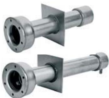
Fabricados em aço inoxidável 18/8 AISI-304. As duas extremidades com rosca interior 1 ½". Com uma tomada equipotencial. Para a boca 16331.
