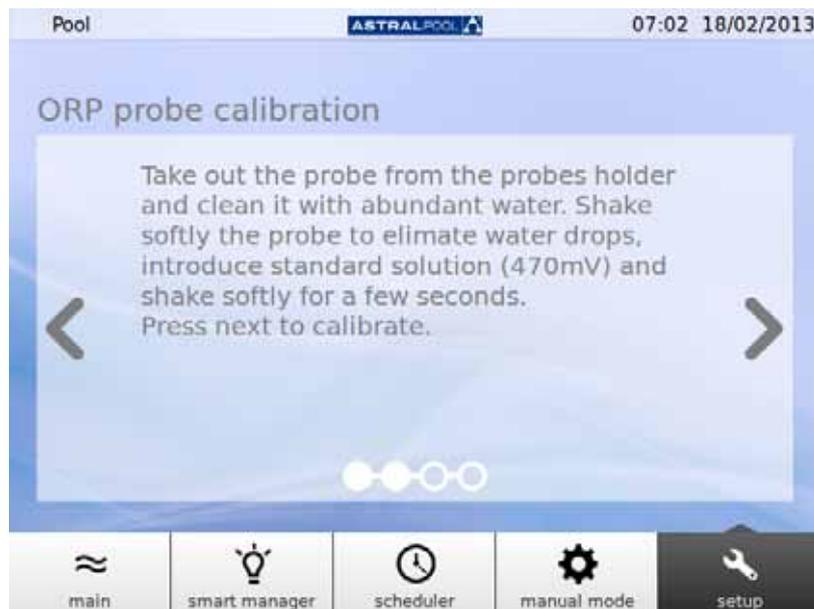
Fig. 34: Inserire la soluzione standard
