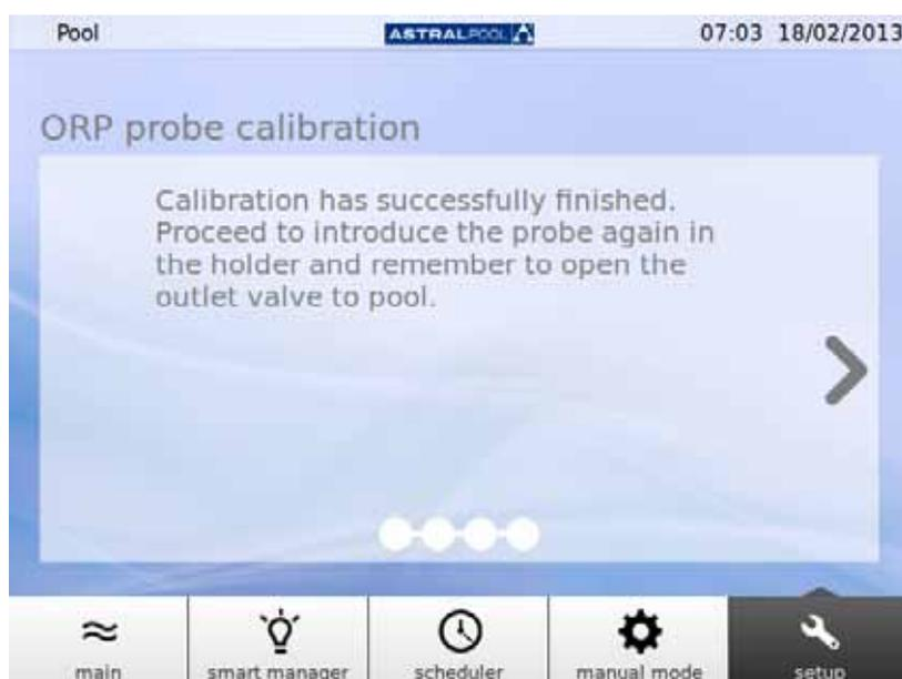
Fig. 37: Calibrazione eseguita
