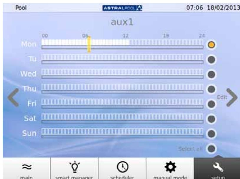
Fig. 20: Utilità di pianificazione dei dispositivi ausiliari
