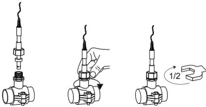
2) Insertar sensor pH/ORP en racord. Enroscar el sensor pH/ORP en el racord con la mano y dar segundo apriete con una llave fija.
