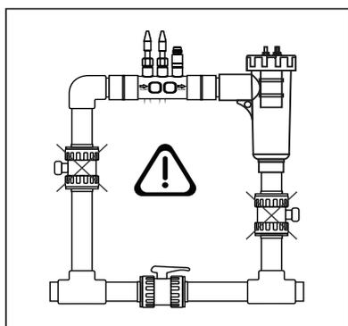
**ATENCIÓN:** el detector de flujo (detector gas) no funcionará correctamente, con el consiguiente riesgo de ruptura de la célula, si se cierran simultáneamente las válvulas de entrada y salida a la tubería donde va instalada la célula de electrolisis. Aunque resulta una situación inusual, se puede evitar bloqueando, una vez instalado el equipo, la válvula de retorno hacia la piscina, de forma que no pueda ser manipulada accidentalmente.
