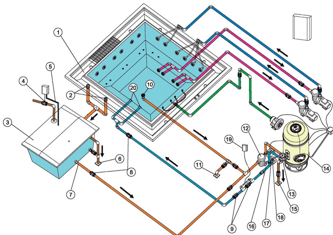
Wasserlaufschema des Spas mit Überlaufrinne. Option A
