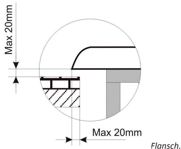
Nachdem das Spa einmal korrekt aufgestellt ist, können die restlichen Bauarbeiten beendet werden, wobei jedoch berücksichtigt werden muss, dass im Umfeld der Beckenschale mindestens 400 mm Platz gelassen werden müssen, um eventuelle Wartungsarbeiten verrichten zu können. Es dürfen niemals Elemente angebracht werden, die mit dem Becken, den Leitungen oder dem Zubehör des Spas in Berührung kommen. Lassen Sie eine Art Klappe oder sonstige Zugangsmöglichkeit für die Wartungsarbeiten.
