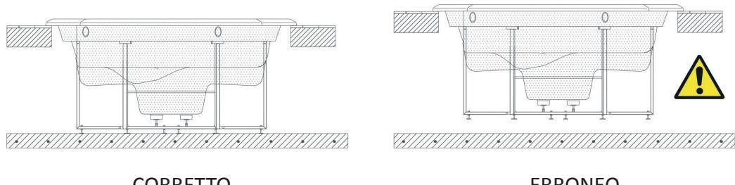
*Schema struttura di supporto Spa.*
