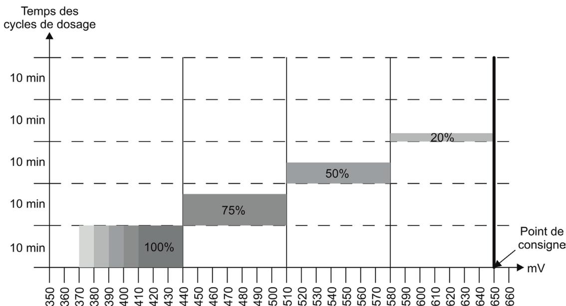
**i** Cette injection proportionnelle est cyclique et la durée des cycles est de 10 minutes. Ce qui va changer le dosage est la répartition des temps d'injection et de pause. La proportionnalité s'ajuste automatiquement et la répartition entre les différents dosages se fait par étape de 70 mV.
