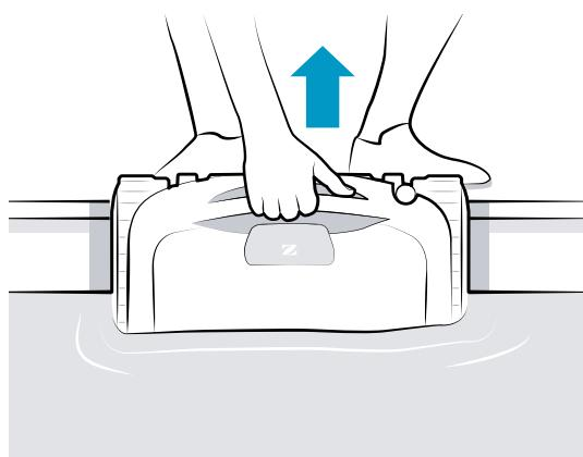
**٣** امسك مقبض الروبوت بالخطاف وارفع الروبوت إلى السطح
