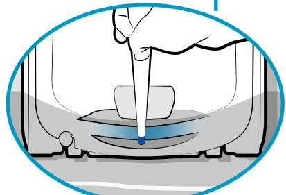
**2** استخدم المقابض لإخراجه تماماً من الماء. يقوم الروبوت بطرد الماء عن طريق نفث الماء للخلف لجعل الروبوت خفيفاً.
