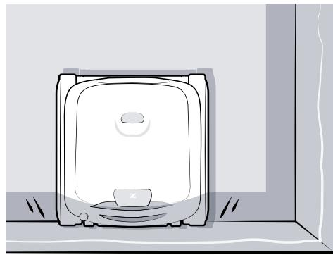
**٤** استخدم المقاييس لإخراجه تماماً من الماء. يقوم الروبوت بطرد الماء عن طريق نفث الماء للخلف لجعل الروبوت خفيفاً
