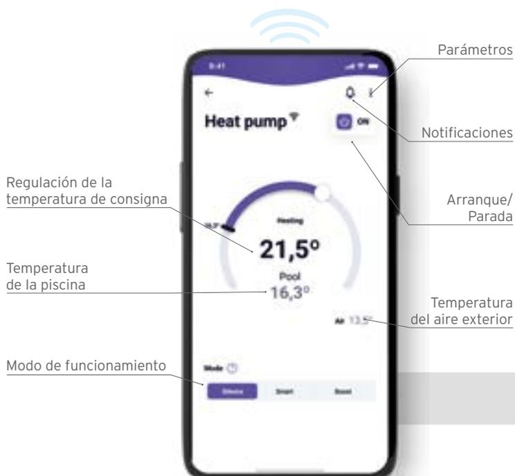
Desde un smartphone, con la aplicación **Fluidra Pool**, la **bomba de calor Z350iQ** se adapta a todos los gustos, ya que se pueden **controlar, configurar y consultar** los diferentes modos de funcionamiento.
