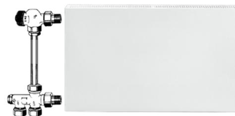
Abb. 67 Einrohranschluss mit hochgezogenem Vorlauf (bauseits)
