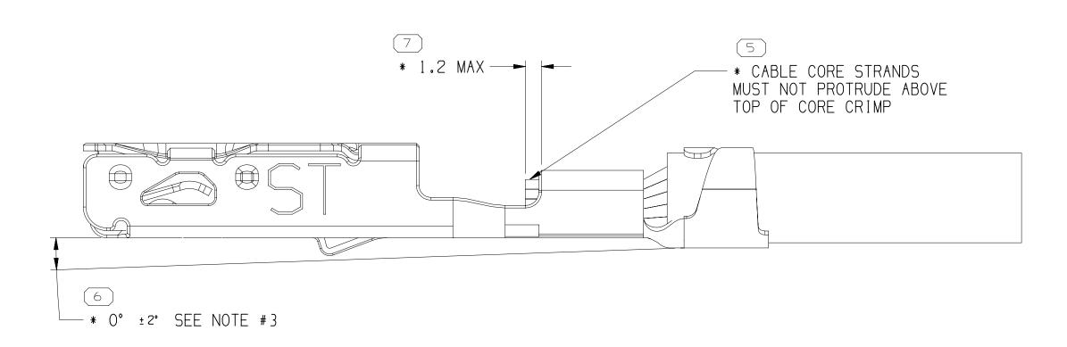
TERMINAL, CABLE ALIGNMENT & POSITION
