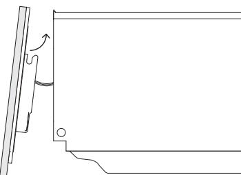
把面板安装在电器上。在重新安装下面板时，建议往回推抽屉滑轨便于安装，如第13页插图所示。
