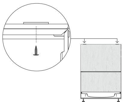
如果安装顶面安装支架，把顶面安装支架固定在安装柜上。
