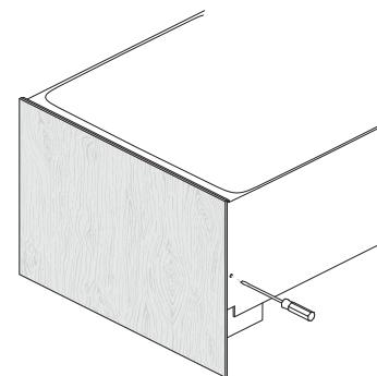
把十字螺丝刀插入每个侧销上面的孔里，转动螺丝刀调节面板对齐。最大调节范围为 $\pm 2\text{mm}$ 。
