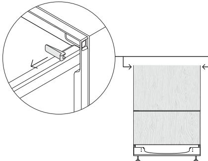
部分打开其中一个抽屉，拆卸镶边条上的第一个螺丝盖。
