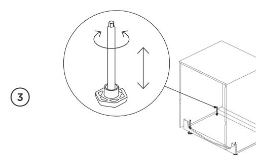
用手或随机提供的内六角扳手和螺丝刀按需要调平DishDrawer™洗碗机。顺时针转动增大每个脚的高度，反时针转动降低高度。
