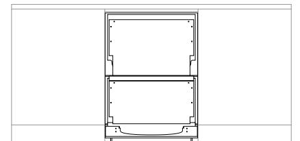
把电器推进安装柜，边推电器边穿水管，避免水管受到挤压或扭曲，小心不要弄弯机脚。
