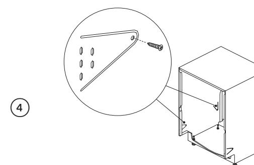
利用背板上的所有4个固定位置固定在安装柜上。
