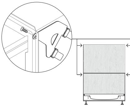
利用支架固定在安装柜上。可能需要根据安装柜材料，预先钻一个导孔。
