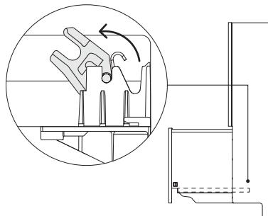
在重新安装抽屉之前，确保水管不扭曲，所有销子面向前方。
