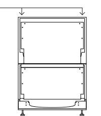
也可以安装两个顶面安装支架。
