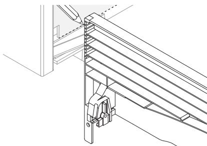
测量踢脚板高度。踢脚板与抽屉底部相遇的地方即为建议的裁切点。
