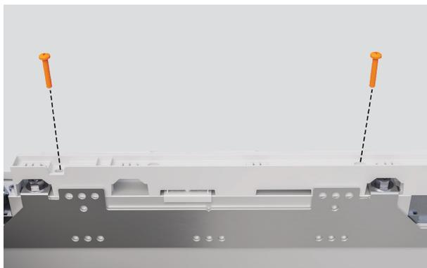
**1.** Dévissez les deux vis cruciformes pour retirer le capot supérieur.
