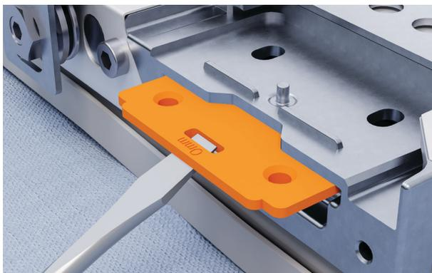
6. Utilisez un tournevis à tête plate pour retirer les plaques intérieures. Passez de le autre côté en veillant à ce que les coins arrondis soient tournés vers l'intérieur .
