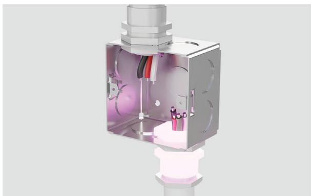
2. Connectez le câble du four à la boîte de jonction via le connecteur de conduit homologué UL.
