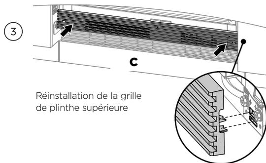
Réinstallation de la grille de plinthe supérieure
