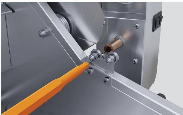
**3.** Inserte el extremo afilado de la barra en el motor del rostizador. Descanse el otro extremo sobre los rodillos en el lado opuesto del asador.
