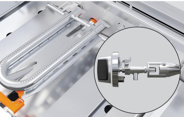
**3.** Reajuste el quemador para que la entrada quede centrada en el surtidor de gas, luego baje el quemador sobre los soportes en la parte trasera. Asegúrese de que quede nivelado y fijo.
