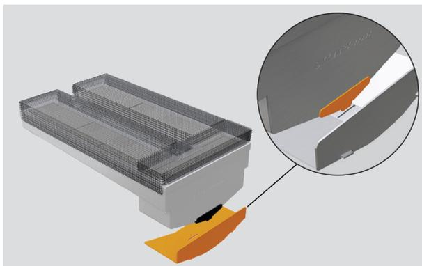
3. Sostenga el quemador para dorar por los lados y ajuste la entrada del quemador de nuevo en la abertura, en frente del asador. Asegúrese de que esté alineado correctamente en la válvula dentro de la abertura. Bájelo en la parte trasera para reajustarlo de forma segura sobre el montaje. Reajuste de la malla.
