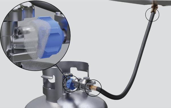
2. Aplique agua jabonosa a todas las conexiones, mangueras y accesorios desde el cilindro hasta la conexión en el asador.
