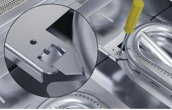
**1.** Retire las parrillas y las charolas radiantes. Utilice un destornillador plano para aflojar las abrazaderas, luego levante cuidadosamente el quemador hacia arriba y sáquelo del asador.
