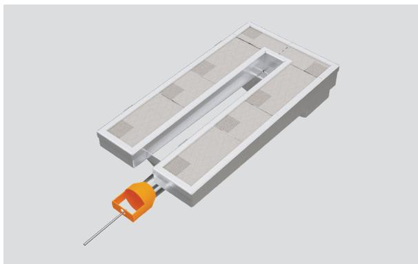
**2.** Revise la entrada del quemador para detectar obstrucciones. Use un pasador de seguridad o un clip para desbloquearlo.
