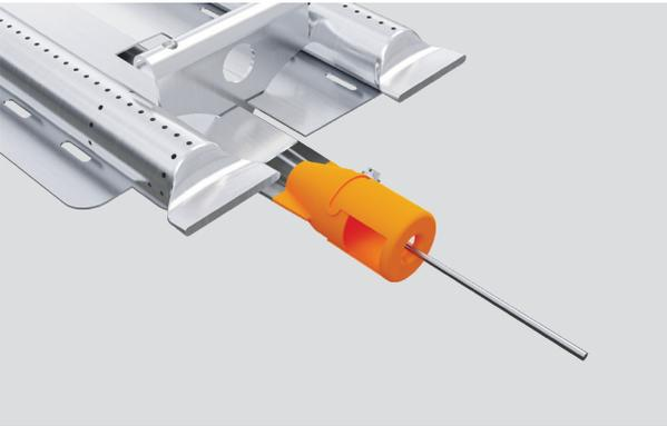
**2.** Utilice una linterna para comprobar si la entrada del quemador está obstruida. Si es así, use un pasador de seguridad o un clip para papel para desbloquear la entrada y los orificios a lo largo del tubo del quemador.
