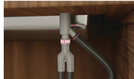
Insérez l'attache métallique sur le tuyau avant d'installer le tuyau sur le raccord pour tuyau fourni. Fixez à l'aide des colliers de serrage. Installez sur l'ensemble de coupure anti-retour. Assurez-vous que le tuyau s'insère en ligne droite dans le raccord, en enlevant tout excédent du tuyau d'évacuation.
