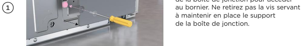
Dévissez et retirez le couvercle de la boîte de jonction pour accéder au bornier. Ne retirez pas la vis servant à maintenir en place le support de la boîte de jonction.
