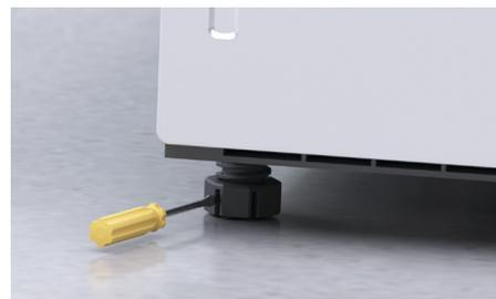
En utilisant un tournevis à pointe plate, tournez pour élever les pattes de nivellement. Mettez de niveau la partie arrière, en commençant par les pattes extérieures, suivies des pattes avant. N'ajustez pas la patte centrale arrière à ce moment.
