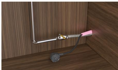
Acheminez le câblage au travers du trou pour raccords dans la paroi de l'armoire. Fixez-le au plancher en appliquant du ruban adhésif.
