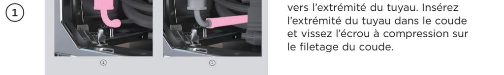
**Raccordement de tuyau en cuivre :**
