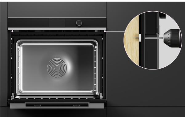
**3.** Befestigen Sie den Backofen mit den mitgelieferten 2 x #7x13 Flachkopfschrauben am Einbauraum.
