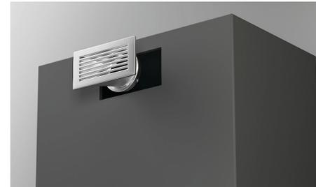
Créer une découpe dans votre meuble pour l'adapter à la ventilation de 150 mm. Placer la ventilation sur le trou créé et la fixer.
