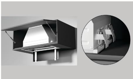
Soulever la hotte dans la cavité jusqu'à ce que les quatre supports de fixation s'enclenchent. Vérifier que les supports de fixation sont bien engagés sur les meubles avant de relâcher la hotte. S'assurer également que le câble d'alimentation reste libre pendant ce processus.
