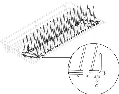
Alignez les clips avant et arrière avec la grille de la base et enclenchez la grille en place.
