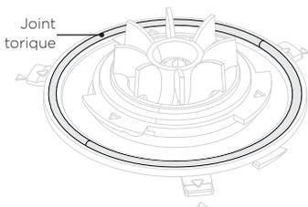
**Avant de réinstaller la plaque de filtration, assurez-vous que le joint torique soit correctement positionné dans la cuve, comme illustré. Si le joint torique n'est pas correctement installé avant l'exécution d'un cycle, des dommages au produit pourraient survenir.**
