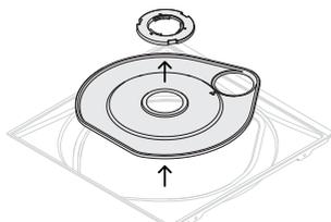
Retirez le filtre, le bras gicleur, l'écrou de blocage et la plaque de filtration dans le bas du tiroir. Utilisez une éponge pour enlever toute eau restante sous les pièces avant de les réinstaller.
