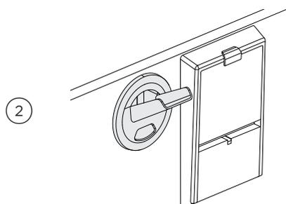
2 Placez l'entonnoir à sel sur le lave-vaisselle DishDrawer™, puis versez doucement le sel dans le réservoir.
