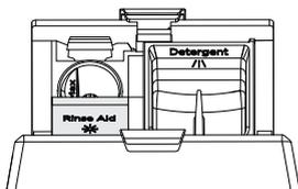
Soulevez le couvercle pour l'ouvrir et versez le produit de rinçage dans l'ouverture, en veillant à ne pas en renverser dans le tiroir ou le compartiment à détergent.
