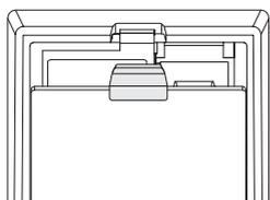
Appuyez sur le loquet pour ouvrir le distributeur avant de soulever le couvercle du distributeur de produit de rinçage.
