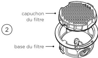
Faites pivoter le filtre dans le sens contraire des aiguilles d'une montre jusqu'à ce que la flèche dans la cuve pointe vers
