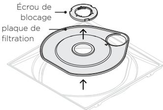
Avec la grille, le filtre de vidange et le bras gicleur retirés, faites pivoter l'écrou de blocage dans le sens contraire des aiguilles d'une montre, puis soulevez-le vers l'extérieur. Soulevez doucement la plaque de filtration, nettoyez-la avec de l'eau chaude savonneuse, puis rincez-la bien. Assurez-vous que le joint torique soit toujours en place, comme illustré ci-dessous.
