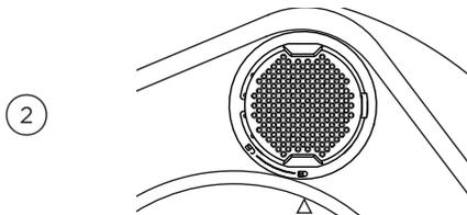
Alignez le capuchon du filtre avec l'encoche sur la base du filtre. Enclenchez-les pour les fixer ensemble.
