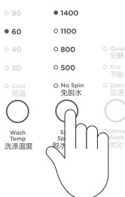
根据需要选择特定洗涤温度和脱水转速，定制洗涤程序。参看**定制洗涤程序**部分了解详情。
