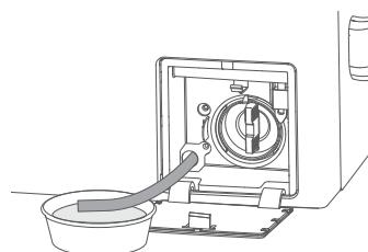
将出水软管轻轻拉出（约 150 毫米）。拔掉出水管堵头，将水（约 250 毫升）排入一个浅盘中。
