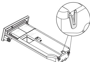
在拆卸洗涤剂抽屉进一步清洗时，打开洗涤剂抽屉背面的两个夹子拆卸盖子。
