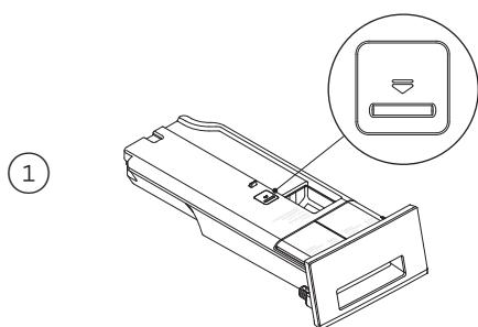
在拆卸洗衣机洗涤剂抽屉时，拉出洗涤剂抽屉并往下按**手动投放**抽屉左侧的锁片，然后把它从洗衣机里拉出来。
