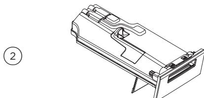
在倒空洗涤剂抽屉时，把水槽里的洗涤剂抽屉翻转过来倒掉**自动投放**抽屉里残留的洗涤剂。
