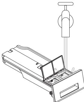
在清洁洗涤剂抽屉时，往抽屉里加热水，稍稍摇晃清除残留洗涤剂。倒空洗涤剂抽屉里的水，然后把洗涤剂抽屉装回洗衣机里。
