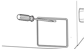
将一字螺丝刀插入插槽，然后撬开盖子。
