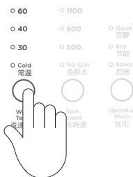
按住要定制的选项对应的按钮3秒钟，例如**洗涤温度**。洗衣机发出一声短提示音，洗涤程序图标闪烁。屏幕显示**SEt**。
