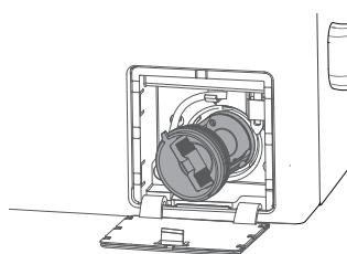
逆时针旋转过滤器，取出过滤器。在水龙头下清洁和冲洗。检查并清理过滤器后面的空腔。清除所有杂物，检查过滤器后面的叶轮是否移动自如。
