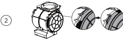
Coloque un filtro de carbono nuevo a cada lado de la entrada del motor y gírelo hasta que encaje en su sitio.
