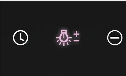
Con la campana extractora APAGADA (OFF), mantenga presionado el botón de luz hasta que los botones adyacentes parpadeen en rojo para CALOR o en blanco para FRÍO.
