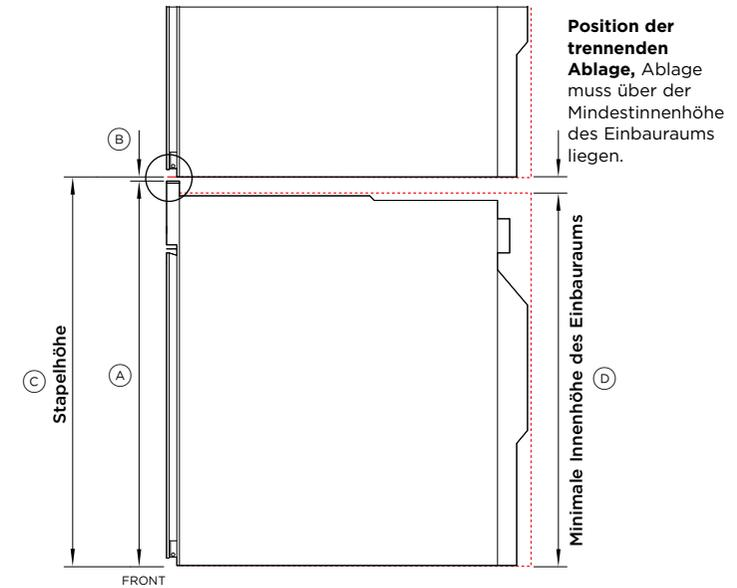
**Position der trennenden Ablage**, Ablage muss über der Mindestinnenhöhe des Einbauraums liegen.
