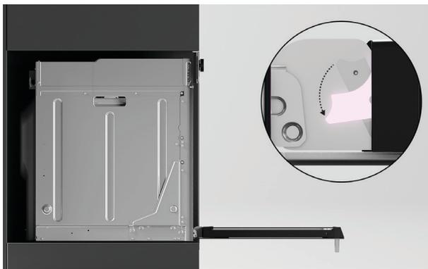
2. Abra la puerta completamente y empuje cada palanca de bloqueo hacia abajo para asegurarla.
