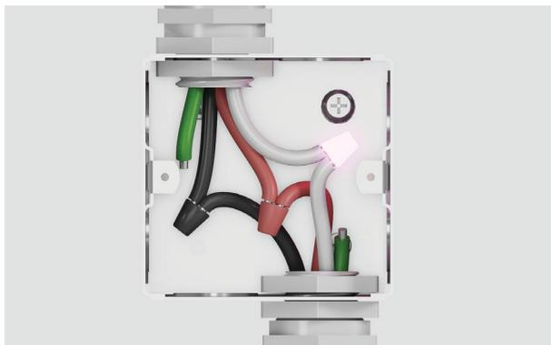
1. Separe los cables verde y blanco del horno. Conecte el cable blanco del horno al cable neutro (blanco) en la caja de conexiones.
