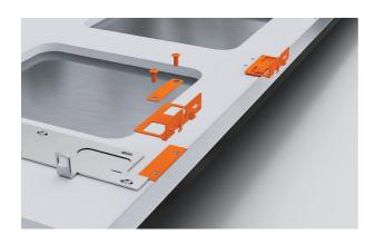
6. Richten Sie die seitlichen Halterungen auf die Blende aus. Mit den mitgelieferten Schrauben befestigen. Vergewissern Sie sich, dass die Halterungen fest sitzen und die Verbindungselemente gerade ausgerichtet sind.
