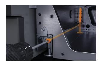
2. Passen Sie die Rückseite des Produkts an, indem Sie die rechte Schraube im Uhrzeigersinn drehen, um die Füße abzusenken.
