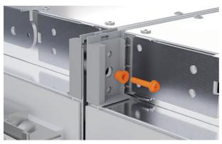
3. Klemmen Sie die oberen Halterungen zusammen, indem Sie die mitgelieferte M5-Schraube und Verbindungshülse anbringen. Mit einem 8-mm-Steckschlüssel und einem Kreuzschlitzschraubendreher festziehen, bis die Hülse bündig
