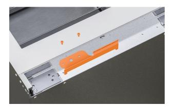
**5.** Entfernen Sie auf der Gegenseite die Nischenhalterung, indem Sie die M6x16-Senkkopfschrauben lösen.
