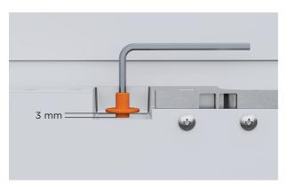
**3.** Lösen Sie die M8-Schrauben um 3 mm.
