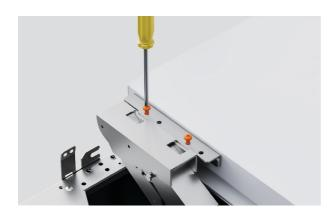
2. Nehmen Sie die Tür vom Gerät ab, indem Sie die M6x10-Sechskantschrauben des Türscharniers (4x) am oberen Scharnier und am unteren/ mittleren Scharnier lösen.
