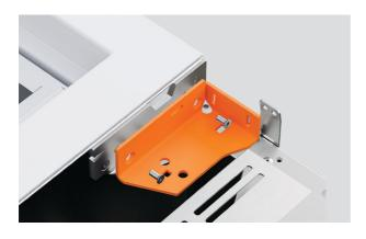
1. Montieren Sie eine neue untere Scharnierhalterung auf der neuen Scharnierseite mit zwei M6x16-Schrauben.
