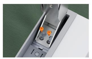
**3.** Befestigen Sie das Scharnier mit zwei M6x16 Senkschrauben in der Tasche.
