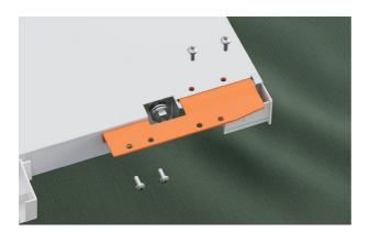
**3.** Montieren Sie die neue obere Adapterhalterung mit vier M5x10 Schrauben auf der anderen Seite der Oberseite der Tür.
