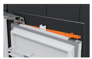
**3.** Halten Sie die Blende in einem Winkel von der Oberseite der Tür und senken Sie sie auf die Befestigungsschrauben ab.
