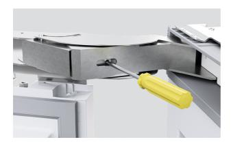
1. Lösen Sie die Scharnierfeder, indem Sie die T20-Schraube im Scharnier in die Position "O" drehen.
