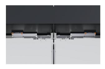
**6.** Befestigen Sie die beiden oberen Halterungen mit zwei Senkkopfschrauben 8x16 auf ieder Seite am Schrank.
