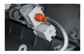
**3.** Schließen Sie den Schlauch an das Absperrventil an.
