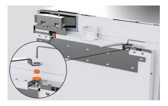
1. Entfernen Sie die M8-Mutter und die M8-Unterlegscheibe von der M8-Schraube oben an der Tür mit dem mitgelieferten Inbusschlüssel und dem Schraubenschlüssel.
