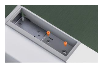
3. Lösen Sie die M6x16-Senkkopfschrauben aus der Scharniertasche, um die Scharniertasche und die obere Alkovenklammer zu entfernen.
