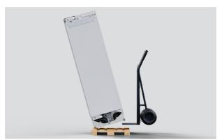
3. Neigen Sie das Gerät leicht nach vorne und schieben Sie den Sackkarren zwischen Palette und Produkt.
