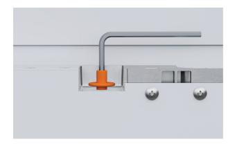
1. Stellen Sie sicher, dass die oberen Befestigungsschrauben um 3 mm gelöst wurden.
