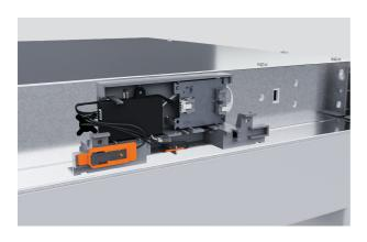
6. Befestigen Sie den Hallsensor im Sensorgehäuse in der Tasche, die der Mittellinie des Schranks am nächsten liegt, bevor Sie die Kabelbaumhalterung in die Gabeln drücken.
