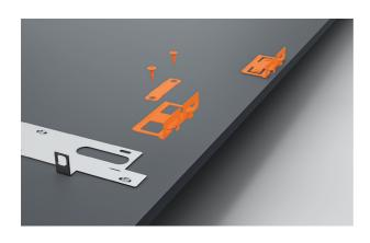
3. Richten Sie die seitlichen Halterungen auf die Blende aus. Mit den mitgelieferten Schrauben befestigen. Vergewissern Sie sich, dass die Halterungen fest sitzen und die Verbindungselemente gerade ausgerichtet sind.
