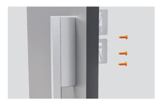
**4.** Befestigen Sie den Griff mit vier M5x25 Sechskantschrauben an der Blende.
