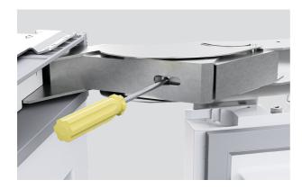
2. Aktivieren Sie die Scharnierfeder, indem Sie die T20-Schrauben in die Position I drehen.
