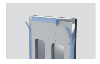
**4.** Entfernen Sie das blaue Klebeband, das an den Innenkanten der Türverkleidung angebracht ist, nachdem der Griff installiert wurden.
