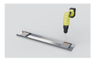
**2.** Befestigen Sie die Magnete an den Abstandshaltern.
