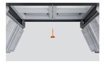
1. Positionieren Sie die Mitte der Verkleidung zwischen den Produkten.
