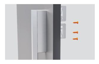
7. Coloque la manija en los paneles con cuatro tornillos hexagonales M5x25. Asegúrese de que las fijaciones de las manijas no obstaculicen los soportes laterales.
