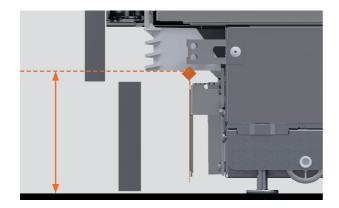
2. Mida la distancia desde el piso hasta la parte inferior de la rejilla para determinar la posición de la placa de montaje del zócalo.
