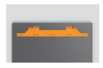
**4.** Alinee el soporte del panel de la puerta con el panel. Asegúrelo con los tornillos suministrados.
