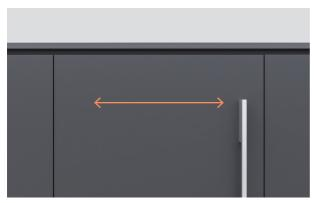
**6.** Empuje el panel de lado a lado para ajustarlo horizontalmente. Asegúrese de que los paneles estén alineados con la parte frontal del gabinete.
