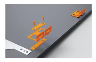
**5.** Alinee los soportes laterales con el panel. Asegúrelos con los tornillos suministrados. Asegúrese de que los soportes queden bien ajustados y los sujetadores estén rectos.
