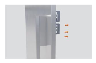
**5.** Coloque la manija en los paneles con cuatro tornillos hexagonales M5x25.
