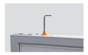
1. Asegúrese de que los tornillos de montaje superiores se hayan aflojado y de que estén en su posición más baja
