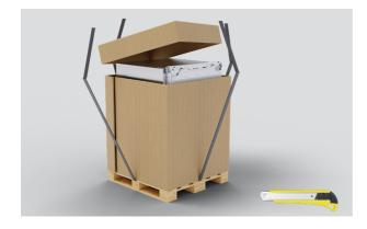
1. Corte las correas, abra la parte superior y corte el lateral de la caja para retirarla. Retire todas las piezas previamente empaquetadas.
