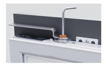
**5.** Ajuste sin apretar los tornillos laterales y las arandelas superiores M8 con la llave inglesa y la llave L suministradas en el kit de instalación.
