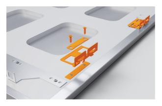
**4.** Alinee los soportes laterales con el panel. Asegúrelos con los tornillos suministrados. Asegúrese de que los soportes queden bien ajustados y los sujetadores estén rectos.
