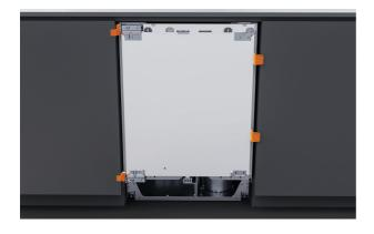
1. Empuje el producto hacia adentro hasta que los medidores de profundidad toquen la parte delantera del hueco. Asegúrese de que el cable de alimentación no quede atrapado.
