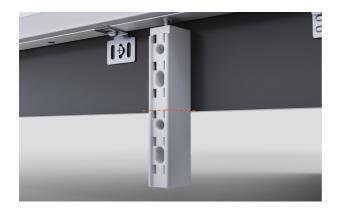
1. Con la puerta abierta, alinee el divisor de flujo con la base de la puerta. Con una sierra para metales o un cúter lateral, corte el divisor para asegurarse de que no sobresalga por debajo del panel de la puerta.
