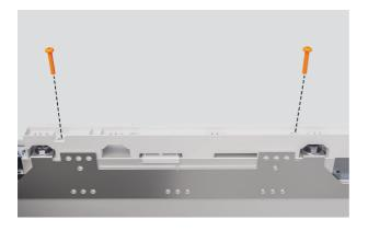
**4.** Retire la cubierta superior y apártela.
