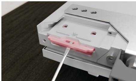
Utilisez un tournevis à pointe plate pour retirer les plaques intérieures. Déplacez-les sur l'autre côté en vous assurant que les coins arrondis soient orientés vers l'intérieur.
