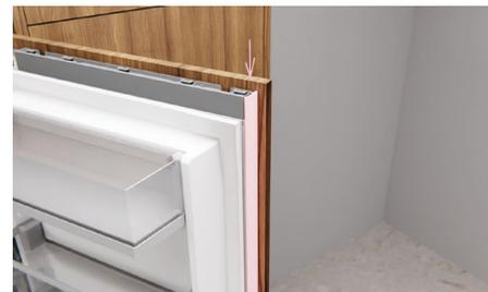
Placez la garniture de porte longue sur le côté sans charnière du produit, puis glissez-la vers le bas pour l'enclencher en place. En présence d'un espace, retirez et réajustez les supports latéraux. Assurez-vous que la garniture ne dépasse pas au-dessus du couvercle supérieur. Répétez pour la porte inférieure.
