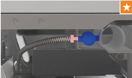
Retirez le capuchon de la valve avant de raccorder le tuyau et de le serrer.
