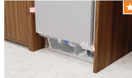
Poussez le produit dans l'alcôve. Poussez vers l'intérieur jusqu'à ce que les jauges touchent l'extrémité de l'alcôve. Assurez-vous que le tuyau n'est pas plié ou entortillé et que le cordon d'alimentation n'est pas coincé.
