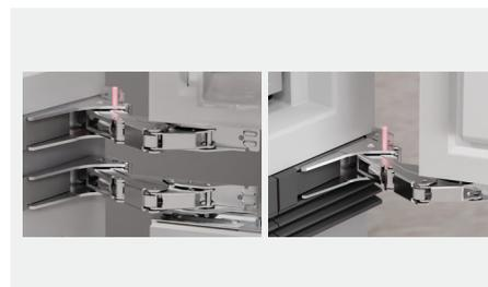
Pour limiter l'ouverture de la porte à 90°, placez la tige de limitation de charnière dans les charnières inférieures des deux portes.
