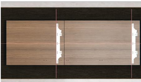
Alignez le support de panneau de porte central sur le panneau en vous assurant que le 'V' dans le support repose sur la ligne centrale.
