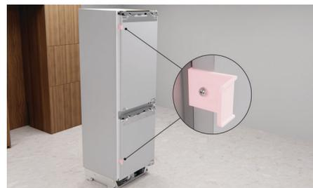
En utilisant les vis cruciformes fournies, installez les jauges de profondeur dans le haut et le bas de la porte, comme illustré.
