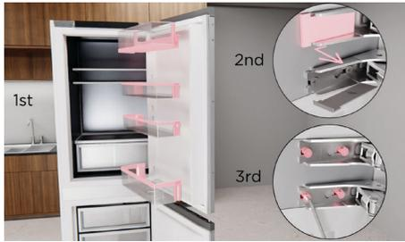
Ouvrez la porte et retirez les tablettes de porte. Dégrafez les couvercles des charnières centrales. Desserrez les vis de charnière à l'aide du tournevis Torx T25 fourni. Glissez la porte vers l'extérieur et placez-la sur une surface protégée.
