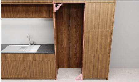
Vérifiez que l'alcôve est à l'équerre et fixée au mur. Assurez-vous que le devant de l'alcôve est à l'équerre avec le haut de l'alcôve et que le plancher est plat.
