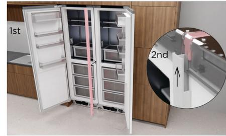
Placez la garniture entre les produits. Abaissez la garniture avant de l'enfoncer pour vous assurer que le support connecteur inférieur est dégagé de la grille. Glissez la garniture vers le haut jusqu'à ce qu'elle s'emboîte dans le support supérieur.
