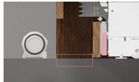
Poussez la plinthe pour la remettre à la profondeur souhaitée avant de la retirer. Si la profondeur de la plinthe est inférieure à 3 9/16 po (90 mm), fixez le bloc de mousse supplémentaire.
