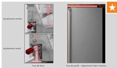
Tournez la vis de droite pour ajuster l'arrière du produit, puis la vis de gauche pour ajuster le devant. Tournez dans le sens des aiguilles d'une montre pour augmenter la hauteur, ou dans le sens inverse pour la réduire.
