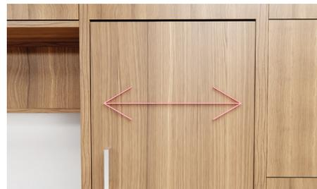
Poussez le panneau d'un côté à l'autre pour l'ajuster à l'horizontale. Assurez-vous que les panneaux sont au même niveau que le devant des armoires.
