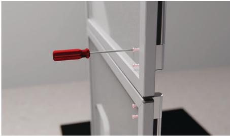
Déterminez l'orientation du panneau en fonction de la position de la charnière et la poignée.
