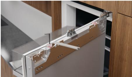
Retirez les deux rondelles et écrous, puis mettez-les de côté. Soulevez les supports de panneau vers l'extérieur pour les retirer.
