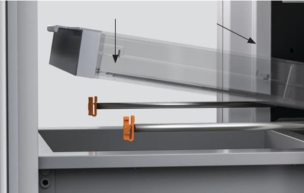
5. Pour remettre le plateau en place, déployez les glissières et placez l'arrière du plateau dessus. Fixez le plateau aux glissières pour le sécuriser.
