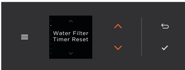
2. Appuyez sur **▼** ou **▲** pour faire défiler jusqu'à **WATER FILTER TIMER RESET (RÉINITIALISATION DE LA MINUTERIE DU FILTRE À EAU)**.
