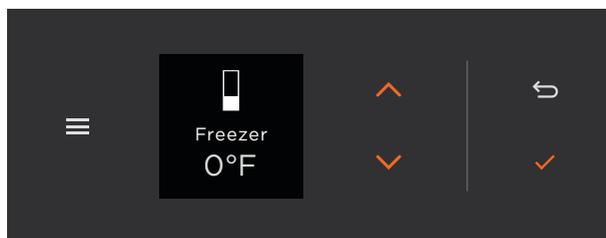
1. Appuyez sur  $\nabla$  ou  $\blacktriangle$  pour sélectionner le compartiment inférieur, puis appuyez sur  $\checkmark$  pour confirmer.
