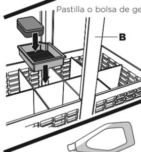
Si utiliza una pastilla o bolsa de gel, colóquela en el cesto para cubiertos (B) o en el borde del estante de base (consulte la guía del usuario para obtener detalles).
