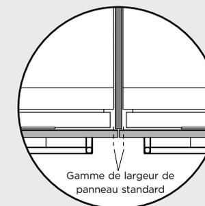
Le nombre maximal d'appareils par cavité est de trois. Si deux cavités sont nécessaires, une pièce d'espacement avec des panneaux plus larges peut être utilisée.
