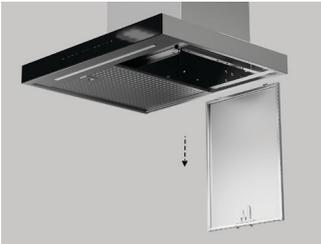
Jale el cerrojo e incline el filtro hacia abajo hasta que esté en posición vertical y a continuación, levante el filtro para desengancharlo de los soportes.
