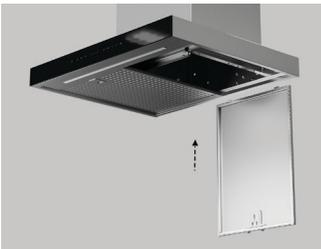
Enganche el filtro en posición vertical dentro de las ranuras en la parte trasera de la campana de la estufa. Levante el filtro hasta que las prensas engranen totalmente.
