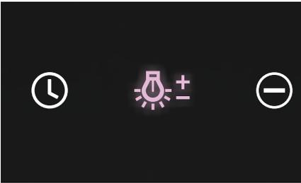
Con la campana extractora APAGADA (OFF), mantenga presionado el botón de luces hasta que los botones adyacentes parpadeen en rojo para CALOR o en blanco para FRÍO.
