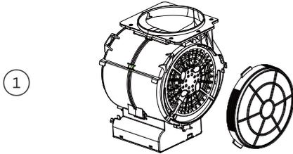
Retire los filtros de aluminio de la campana extractora antes de retirar los filtros de carbono.
