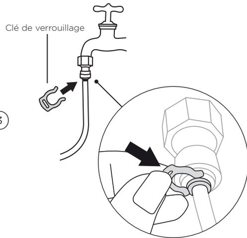
Raccordez le tuyau court à la sortie du robinet et fixez-le à l'aide de la clavette de blocage.
