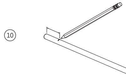
Mesurez 5/8 po (16 mm) à partir d'une extrémité du tuyau de sortie et marquez une ligne.
