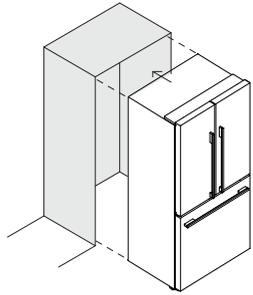
Faites rouler le réfrigérateur vers son emplacement en vous assurant que le dégagement est adéquat entre le produit et les armoires adjacentes. Vérifiez les mesures de dégagement minimal dans le tableau de dimensions d'encastrement.
