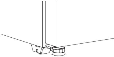
Dévissez les pieds avant jusqu'à ce que le réfrigérateur soit incliné vers l'arrière, avec la partie avant environ 3/8 po (10 mm) plus haute que la partie arrière. Il sera ainsi plus facile de fermer la porte.
