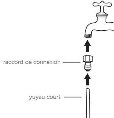
Raccordez le raccord au robinet.
