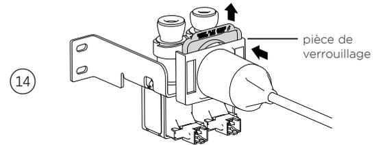
Glissez le couvercle jusqu'à l'orifice d'entrée d'eau. Tirez la pièce de verrouillage vers le haut, puis poussez sur le couvercle jusqu'à ce qu'il s'enclenche dans l'orifice d'entrée.
