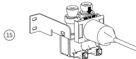
Vérifiez que le couvercle est aligné correctement. Poussez la pièce de verrouillage vers le bas pour verrouiller le couvercle en place.
