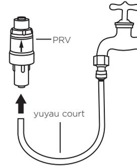
Raccordez l'entrée de la vanne de réglage de pression au tuyau raccordé au robinet. Assurez-vous que la flèche sur la vanne de réglage de pression est dirigée à l'opposé du robinet. La flèche indique le sens du débit d'eau.
