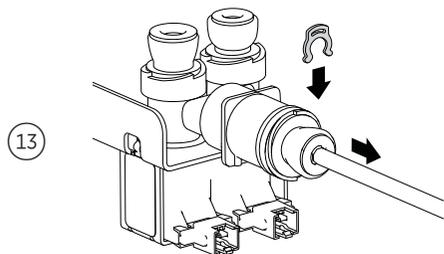
Insérez une clavette de blocage, puis tirez doucement sur le tuyau pour vous assurer qu'il est bien verrouillé en place.
