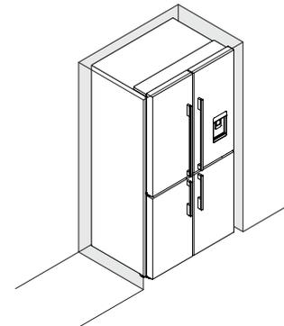
Remplacez le réfrigérateur en position et réglez les pieds avant. Vérifiez que l'alignement et la fermeture de la porte sont satisfaisants.
