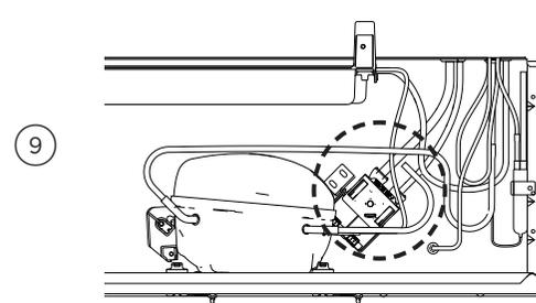
Acheminez le tuyau de 1/4 po (6 mm) à l'arrière du réfrigérateur en vous assurant de laisser une longueur de tuyau suffisante pour pouvoir avancer le réfrigérateur lors des travaux d'entretien.
