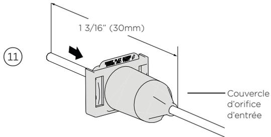
Insérez une extrémité du tuyau de sortie dans l'ouverture pour tube du couvercle d'orifice d'entrée d'eau, puis glissez-le vers l'arrière d'environ 1 3/16 po (30 mm).
