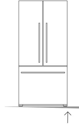
Poussez légèrement le réfrigérateur vers l'arrière jusqu'à ce que les roulettes arrière reposent au sol.
