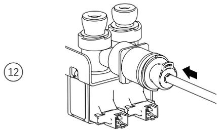
Insérez le tuyau de sortie dans l'orifice d'entrée d'eau (solénoïde) jusqu'au trait.
