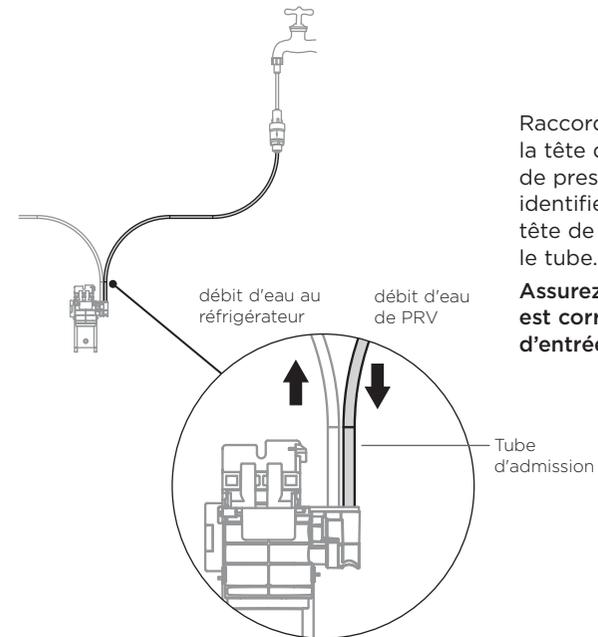
Raccordez le tube d'alimentation de la tête de filtre à la vanne de réglage de pression. Le tube d'alimentation est identifié par la flèche vers le bas sur la tête de filtre et une marque rouge sur le tube.
