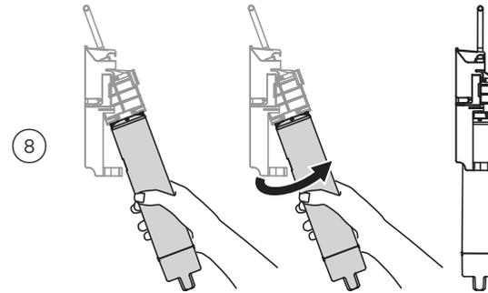
Insérez le filtre à eau dans la tête de filtre. Poussez fermement le filtre dans la tête de filtre et tournez dans le sens des aiguilles d'une montre jusqu'à ce qu'il se verrouille en place.
