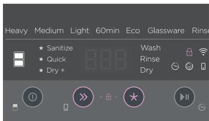
Maintenez enfoncées les touches >> et ★ simultanément pendant 2 secondes. Un signal sonore sera émis et 🔒 s'allumera.
