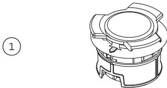
Réenclenchez la grille du filtre de vidange sur le support et faites pivoter jusqu'à ce que les flèches sur la grille et le support soient alignées.
