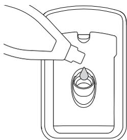
Versez le produit de rinçage dans l'ouverture, en veillant à ne pas en renverser dans le tiroir ou sur les poignées en aluminium.
