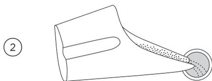
Placez le sel dans le contenant de sel et versez-le avec soin dans le réservoir.
