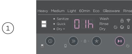
Maintenez la touche **▶▶** enfoncée jusqu'à ce que **1h** apparaisse sur l'afficheur pour accéder au mode **DELAY START** (MISE EN MARCHÉ DIFFÉRÉE).
