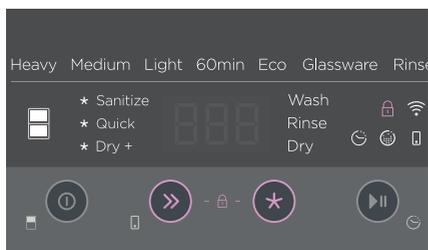
Maintenez enfoncées les touches >> et ★ simultanément pendant 6 secondes. Un signal sonore sera émis et 🔒 s'allumera.
