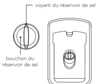
Le réservoir de sel est situé à l'intérieur du tiroir, près du distributeur de détergent. Il peut contenir environ 0,8 lb (350 g) de sel (la capacité réelle varie en fonction de la marque et la taille de grain du sel utilisé).
