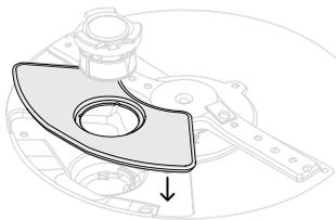
Poussez la plaque du filtre de vidange pour la remettre en place sur la cuve, en vous assurant qu'il n'y ait aucune particule dans la cavité.
