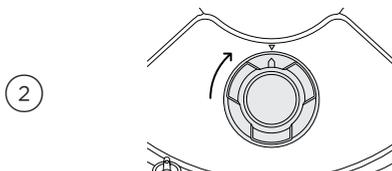
Poussez le filtre de vidange pour le remettre en place dans la cuve et tournez dans le sens des aiguilles d'une montre jusqu'à ce que les flèches sur le filtre et la base du tiroir soient alignées.
