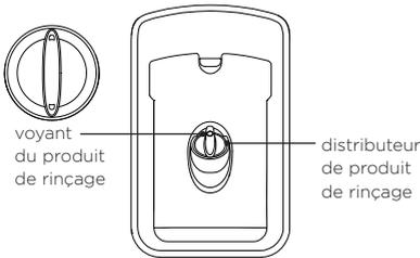
Le distributeur de produit de rinçage est situé à l'intérieur du tiroir, sous le distributeur de détergent. Il peut contenir environ 1,7 oz liq. (50 ml) de produit de rinçage.
