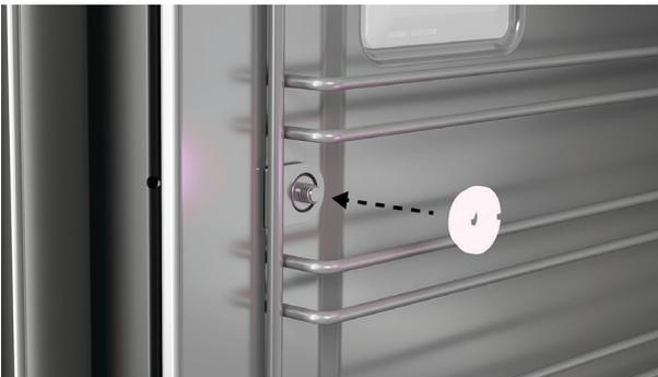
2. Alignez la languette avec la vis et sécurisez à l'aide de l'écrou.
