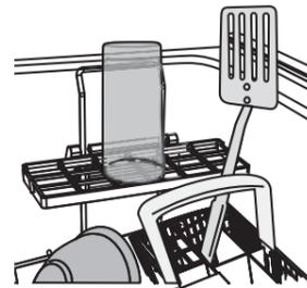
Les objets saillants peuvent empêcher le couvercle interne du lave-vaisselle de se fermer correctement et causer des dommages nécessitant des réparations.
