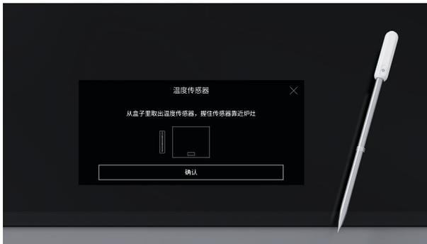
2. 按下
