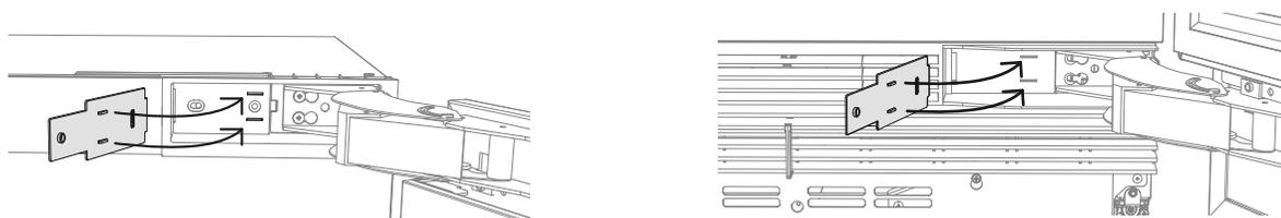
Placez le couvercle sur la cavité de charnière, en faisant correspondre les goujons sur le couvercle avec les fentes dans la cavité de charnière.
