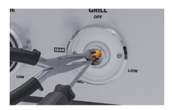
2. Sujete el eje de la válvula de control con unos alicates e inserte un destornillador plano largo y delgado.
