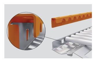
**2.** Asegure las varillas en su lugar empujando el soporte lateral para que encaje.
