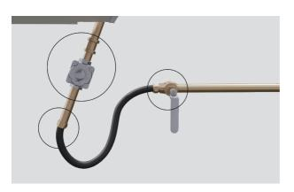
3. Si hay una fuga, cierre de inmediato el suministro de gas, ajuste las conexiones que presenten fugas y vuelva a verificar. Si no puede detener una fuga de gas, cierre el suministro y llame a la empresa proveedora del servicio o al distribuidor al que le compró el electrodoméstico.
