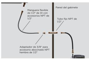
**3.** Si el cilindro se encuentra en un gabinete separado, el instalador debe proteger las tuberías a una distancia de al menos 2" (50 mm) a cada lado de la abertura del cerramiento. Antes de usarlo, se debe instalar un sistema de retención para el cilindro de GLP (no incluido).
