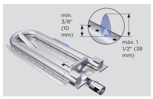
3. Las llamas deben ser azules y estables. Una llama amarilla indica que no hay suficiente aire. Una llama ruidosa que se eleva por sobre el quemador indica que hay demasiado aire. Encienda el quemador para volver a controlar las llamas.
