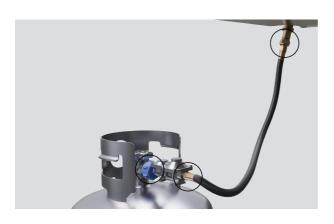
2. Aplique una solución jabonosa preparada con jabón líquido y agua en una proporción de 1:1 a todas las conexiones, mangueras y accesorios desde el cilindro hasta la conexión en la barbacoa.
