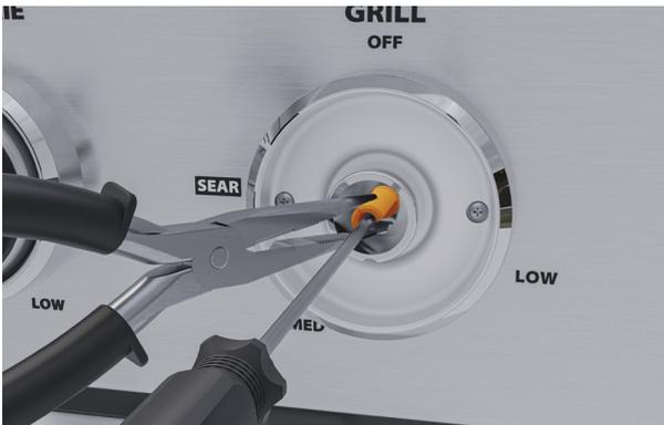
2. Maintenez la tige de la valve de réglage à l'aide de pinces et insérez un long tournevis à tête plate et mince.
