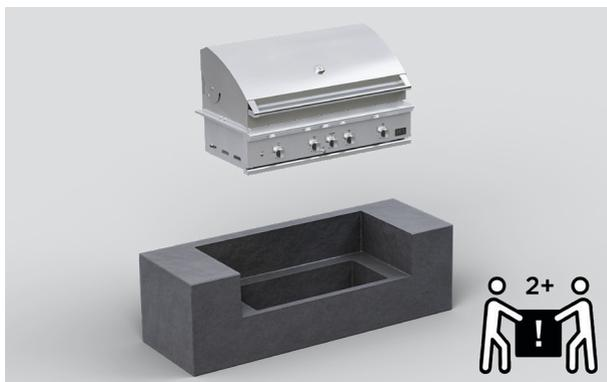
**1.** Pour éviter d'endommager l'assemblage de régulateur avec le poids du gril, ne placez pas le gril sur le sol ou une surface plane.
