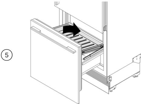
确保中托盘两边落在滑轨上。
