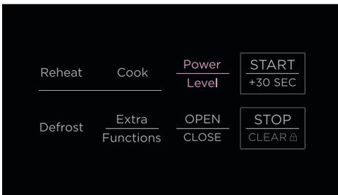
Appuyez sur **POWER LEVEL (NIVEAU DE PUISSANCE)** pour faire défiler les options de niveau de puissance et régler le niveau de puissance initial souhaité.
