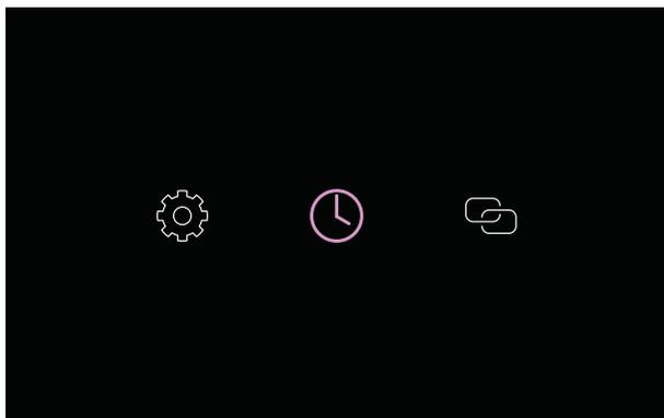
4. Appuyez sur ⌚ pour activer ou arrêter le minuteur d'ARRÊT DIFFÉRÉ. Maintenez enfoncé pour régler la durée du différé.
