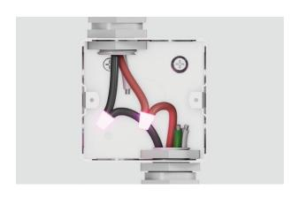
**3.** Conecte los dos cables negros juntos con los conectores de rosca y los dos cables rojos juntos con conectores de rosca.
