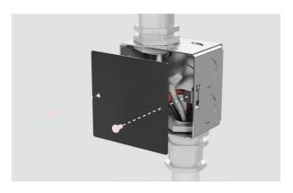
**6.** Vuelva a colocar la cubierta de la caja de conexiones.
