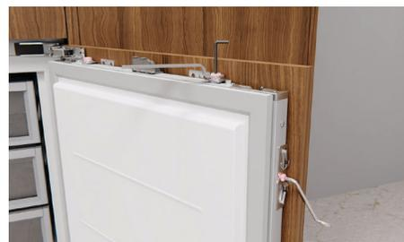
Posizionare le viti laterali del pannello usando il piccolo strumento con testa a croce fornito nel kit di installazione. Per impostare un'apertura massima di 90° dello sportello, usare la chiave a croce in dotazione sulle cerniere laterali.
