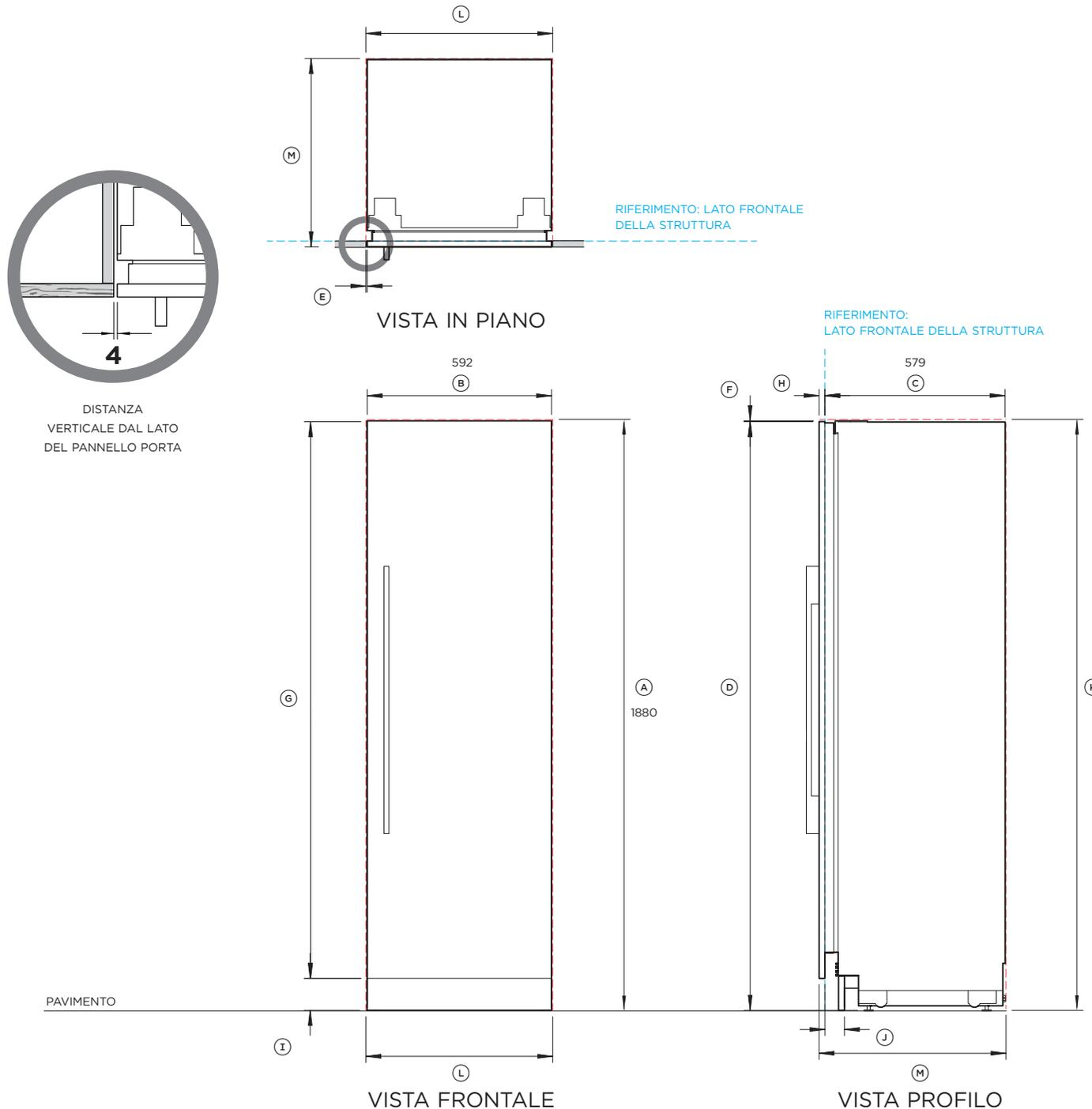
**Frigorifero RS6019S2R1 / RS6019S3RH1 con pannelli in acciaio inossidabile RD6019, Kit maniglia AHD5RDSF e pannello dello zoccolo in acciaio inossidabile AKRS06010**
