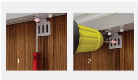
Aprire la porta e allentare la vite della staffa inferiore. Regolare la staffa finché non sia attaccata al pannello porta. Stringere di nuovo la vite e disporre un'altra vite per fissare il pannello.
