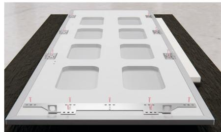
Usando le viti fornite nel kit del pannello, fissare la staffa centrale del pannello porta usando sette viti.
