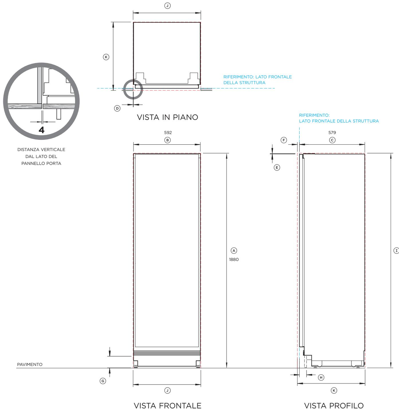
NOTA: La cerniera a sinistra è una versione a specchio dell'immagine illustrata. La cerniera può essere disposta a sinistra usando i pezzi in dotazione.
