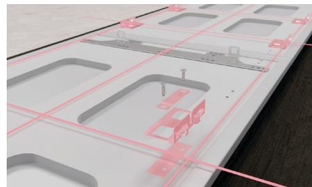
Rimuovere tutto il nastro blu dal pannello. Allineare le staffe laterali ai fori predisposti in base all'orientamento della cerniera. Le etichette rosse indicano installazioni con cerniera a sinistra, le etichette blu indicano installazioni con cerniera a destra.
