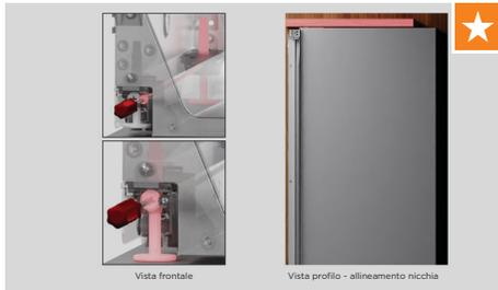
Ruotare la vite destra per regolare la parte posteriore del prodotto e successivamente la vite sinistra per regolare la parte frontale. Ruotare in senso orario per sollevare l'apparecchio e in senso anti-orario per abbassarlo. Assicurarsi che i piedini tocchino terra e che la staffa superiore tocchi il soffitto della nicchia.
