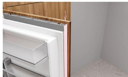
Posizionare il profilo lungo sul lato senza cerniera del prodotto e farlo scorrere fino ad incastro. Se è presente un vuoto, rimuovere e regolare di nuovo la posizione delle staffe laterali. Assicurarsi che il profilo non sporga al di sopra del coperchio superiore.
