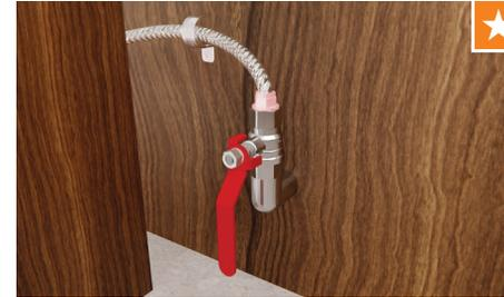
Collegare al rubinetto e aprire il collegamento. Se l'acqua scorre, verificare che non ci siano perdite. Collegare alla corrente e attivare la fornitura elettrica.
