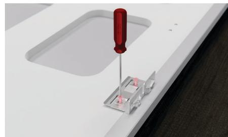
Fissare le staffe laterali usando due viti per staffa dal kit in dotazione. Accertarsi che le staffe laterali siano fissate saldamente e che gli elementi di fissaggio siano stretti.
